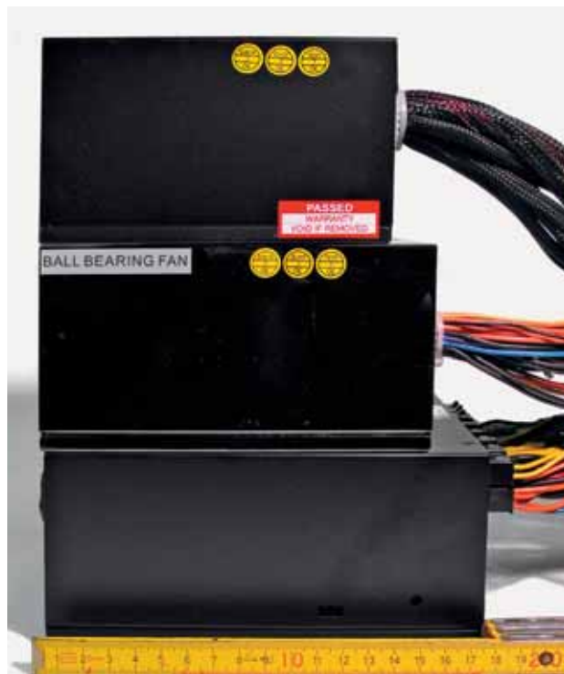
Gehäusetiefe: Einige Hersteller verwenden sehr tiefe Netzteilgehäuse, die unter Umständen zu Kompatibilitätsproblemen führen können.
