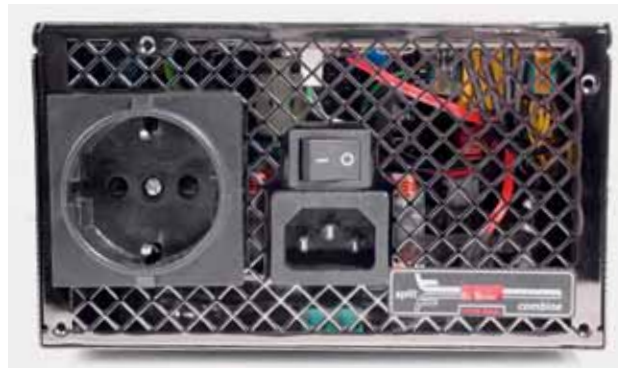
Alte Idee neu aufgelegt: Beim Northq-Netzteil kann ein zusätzlicher Verbraucher (beispielsweise der Monitor) mit angeschlossen werden.
