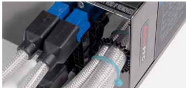
Mäntel: Solche steifen Metallmäntel machen es schwer, die Kabel zu verlegen und sorgen im schlimmsten Fall für mechanische Spannungen auf dem Mainboard.
