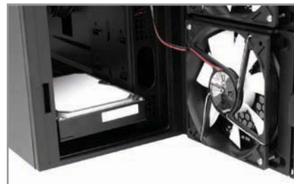
2つの外部3.5インチフリートスワップ(Fleet-Swap™)ドライブベイ(移動可能)
