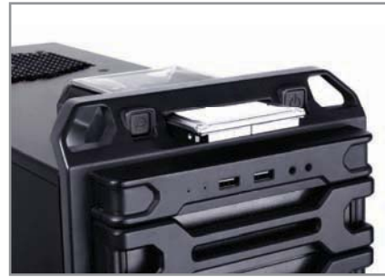
トップ2.5"ホットスワップSATA (SSD対応) ドライブベイ
